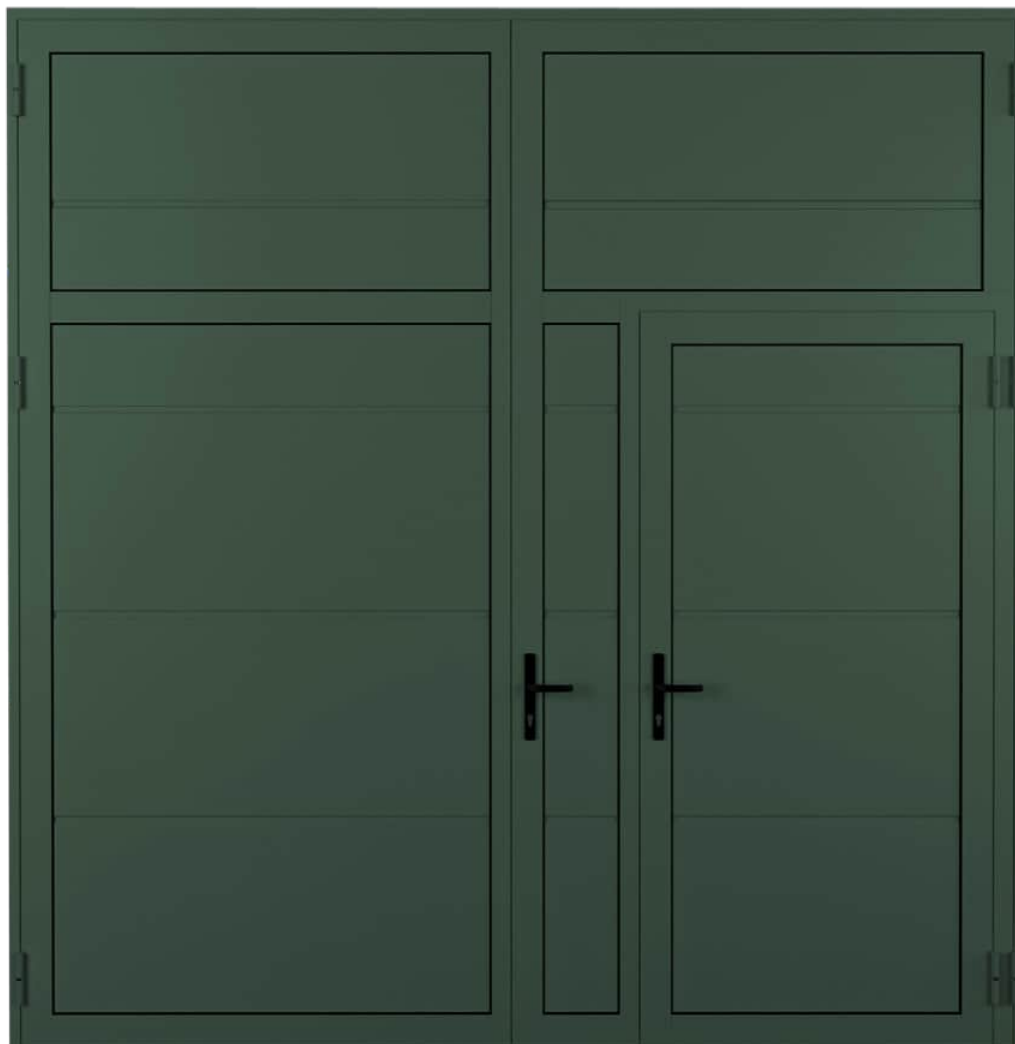
Brama rozwierna dwuskrzydłowa PRESTO 50 z drzwiami przejściowymi - brama o wysokości H_0 \geq 3000 mm lub wyposażona w drzwi przejściowe posiada dodatkową poziomą poprzeczkę wzmacniającą na wysokości 2087 mm
